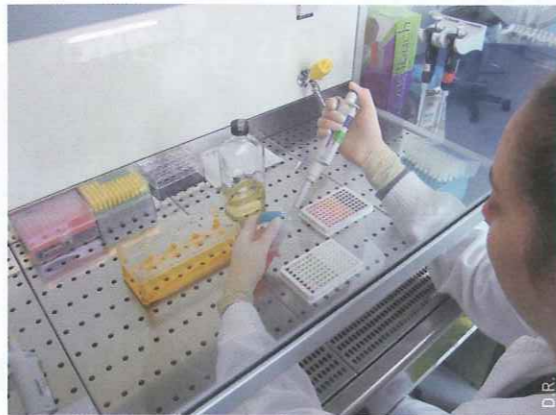
Les échantillons d'eau sont mis en contact avec une diversité de cellules et organismes vivants
